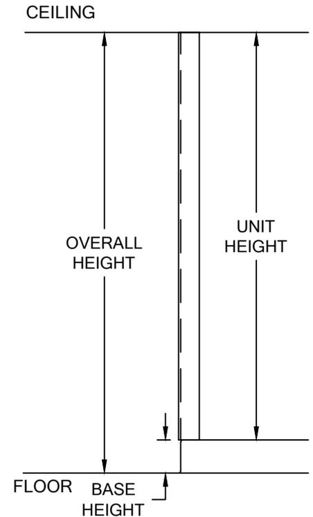
LG-034 CORNER GUARD AT FULL HEIGHT ELEVATION
