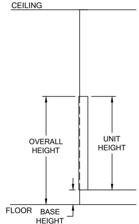
LG-118M CORNER GUARD AT PARTIAL HEIGHT ELEVATION
