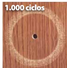
Laminado a baja presión (termofusión)
