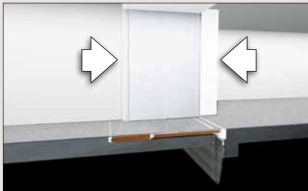
**Completamente cerrada (durante la compresión)** Durante un evento, en el modo de contracción o compresión, la cabina se desliza, completamente, dentro de la estructura contigua.
