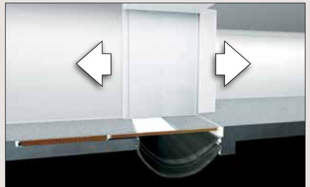
**Completamente abierta (durante la tensión)** Durante un evento, en el modo de expansión o tensión, la cabina se desliza, completamente, hacia afuera.
