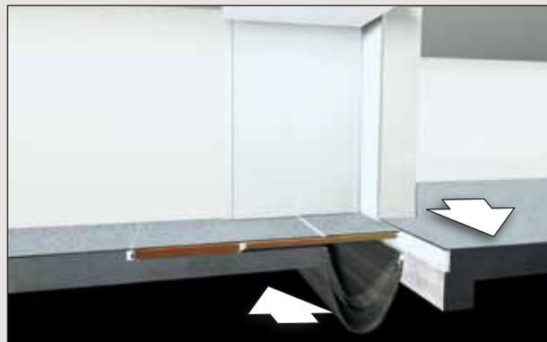
**Cizallamiento lateral** La cabina se adhiere a la estructura fija por medio de un ensamblaje de vía deslizante sin fricción, lo que permite que haya un cizallamiento lateral completo entre construcciones.
